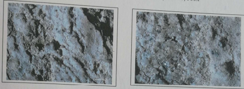
Figure 10, 11. Campione 2 - Morfologia esterna dello strato pittorico, 500x
