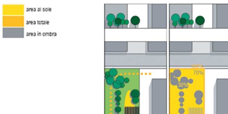
Fig. 3,4: gli accorgimenti progettuali adottati permettono di raggiungere il 30% di superficie in ombra.
