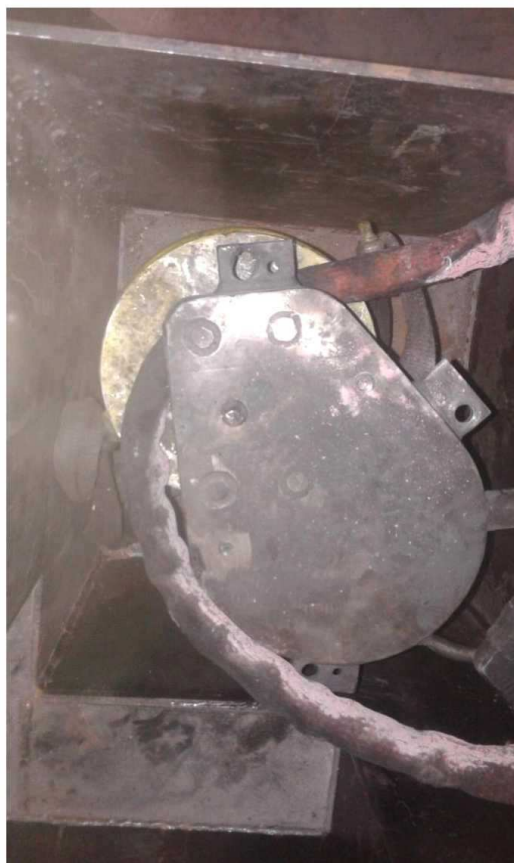
Foto 2 – Sorgente radioattiva, all'interno del contenitore, visivamente integra.
