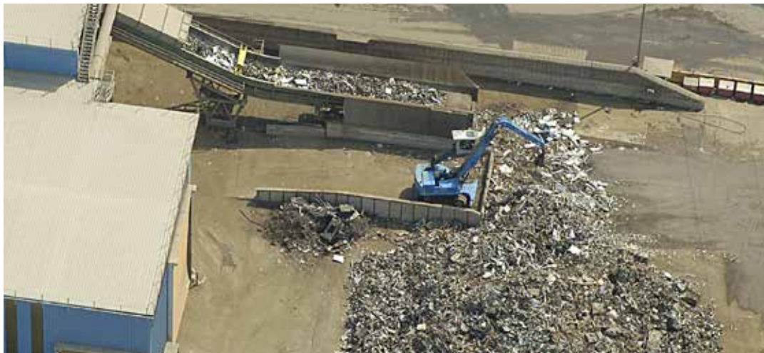
Rottame in fase di caricamento al frantumatore
